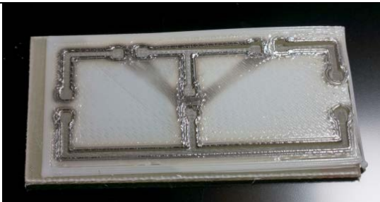
Gedruckte Kunststoffmaske auf FR4 und anschließender Metallisierung mit Palladium
