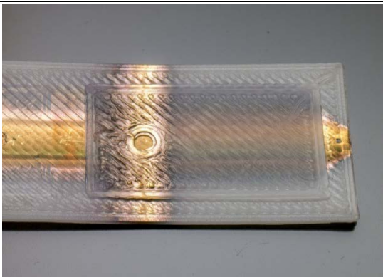
Gedruckter Kunststoff/Goldverbund mit Durchkontaktierung und Leiterzuführung
